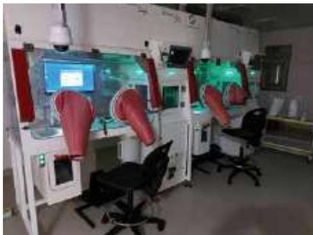
Ugrađen je ispušni sustav za radnu površinu te ventilacijski sustav koji dovodi u odgovarajućoj mjeri pročišćeni svježi zrak u radni prostor. Novi, suvremeniji laboratorij za centralnu pripremu citostatika i biološke terapije u sklopu bolničke ljekarne, započeo
